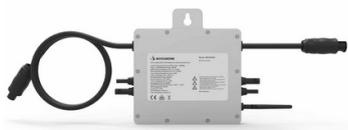
Der Wechselrichter wandelt den Gleichstrom aus dem Solarmodul in Wechselstrom mit einer Spannung von 220 - 230 Volt<sup>1</sup> um. Der Anschluss links kann zu einem weiteren Wechselrichter geführt werden, der Anschluss rechts führt zum Hausnetz. Beide Anschlüsse sind in diesem Fall Spezialstecker Typ „Wieland“.
